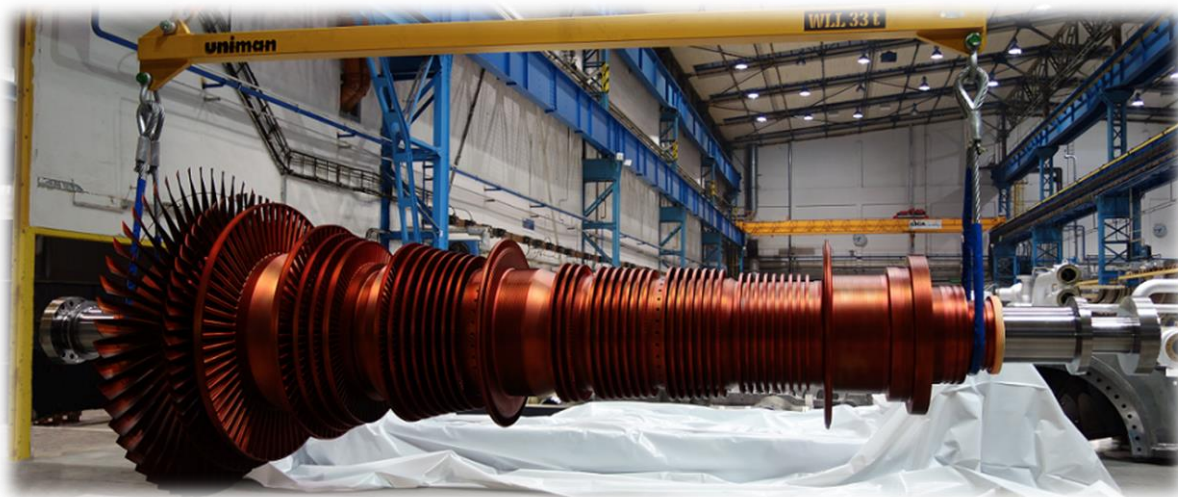
Fot. 14 Wirnik turbiny (waga 35 t) do produkcji energii z gazów hutniczych w elektrociepłowni na terenie huty. Źródło: poland.arcelormittal.com
