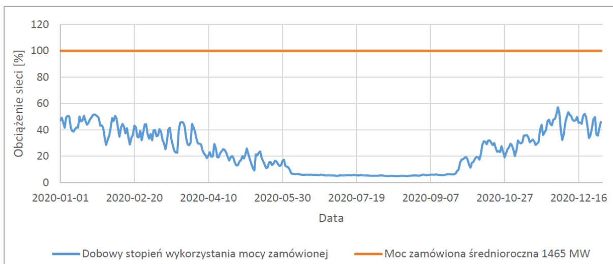
Rysunek 45 Roczny profil obciążenia sieci ciepłowniczej w odniesieniu do średniorocznej wartości mocy zamówionej w źródłach ciepła w 2020 roku.
