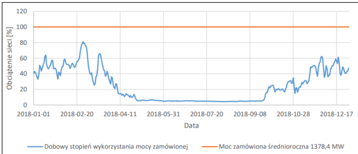
Rysunek 43 Roczny profil obciążenia sieci ciepłowniczej w odniesieniu do średniorocznej wartości mocy zamówionej w źródłach ciepła w 2018 roku.
