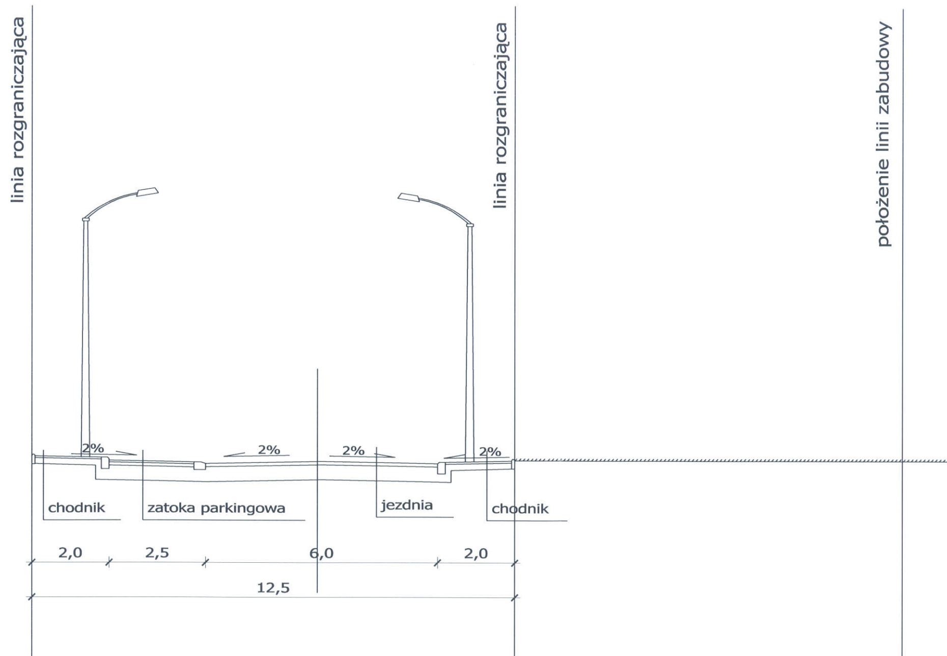
Przekrój typowy - ulica klasy KDW/D (z jednostronnymi zatokami parkingowymi)
