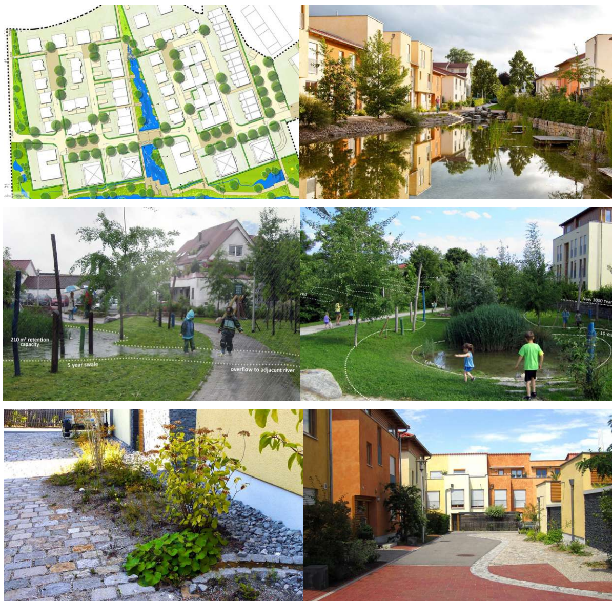
Rys. 167: Wzorcowy przykład osiedla z decentralnym systemem odprowadzenia wód deszczowych - Arkadien Winnenden, Niemcy, StudioDreiseitl ( http://www.dreiseitl.com )
