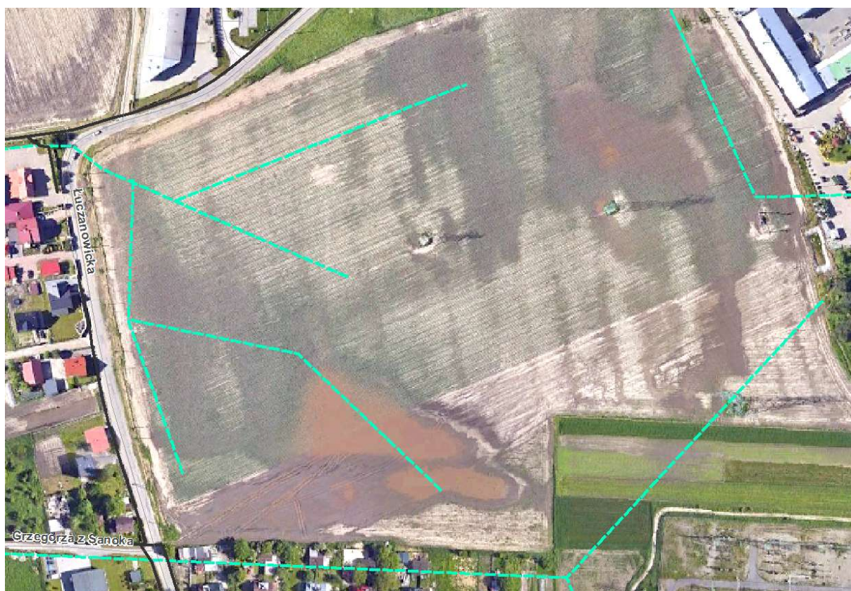
Rys. 30: Rozlewiska po deszczach nawałnych, przerywaną niebieską linią dawne rowy melioracyjne, czarną ciągłą – istn. system odwodnienia (foto: Google Earth. 01.06.2017 – dostęp maj 2018).
