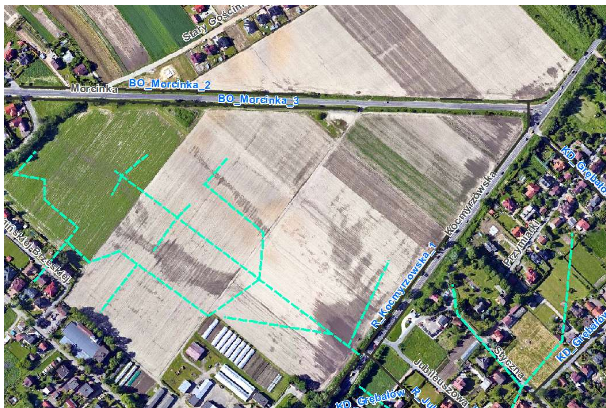
Rys. 39: Ślady po nadmiernym płycie powierzchniowym i zastoiska przy ul. Kantorowickiej, przerywaną niebieską linią dawne rowy melioracyjne, czarną ciągłą – istn. system odwodnienia (foto: Google Earth. 01.06.2017 – dostęp maj 2018).
