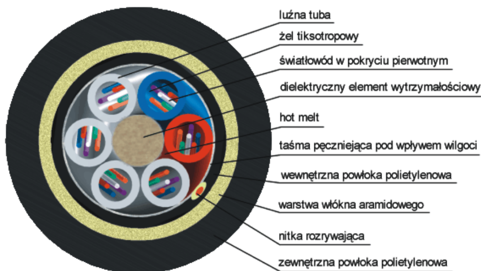
Przekrój poprzeczny przez kabel typu ADSS-XXOTKtsdD
