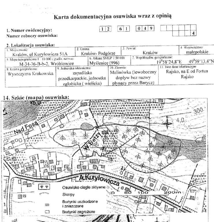
Fig.4.5. Karta dokumentacyjna osuwiska – fragment ilustrujący jej zawartość. Tu karta osuwiska przy ul. Kuryłowicza, w obrębie Soboniowic leży południowo – zachodni kraniec niszy osuwiskowej.
