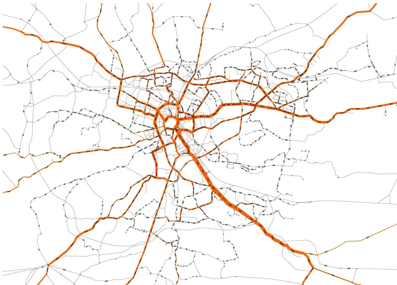
II. 59. Rozkład potoków pasażerskich w godzinie szczytu popołudniowego 2008 r. w pas./h Źródło: Analiza ruchowa dla rozwoju systemów transportowych Krakowa BIT Poznań 2009.
