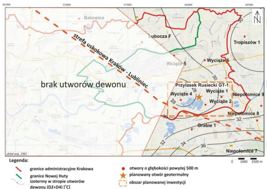
Ryc. 4. Mapa rozkładu temperatur w stropie utworów dewonu (D2=D3) w rejonie Przylasku Rusieckiego
