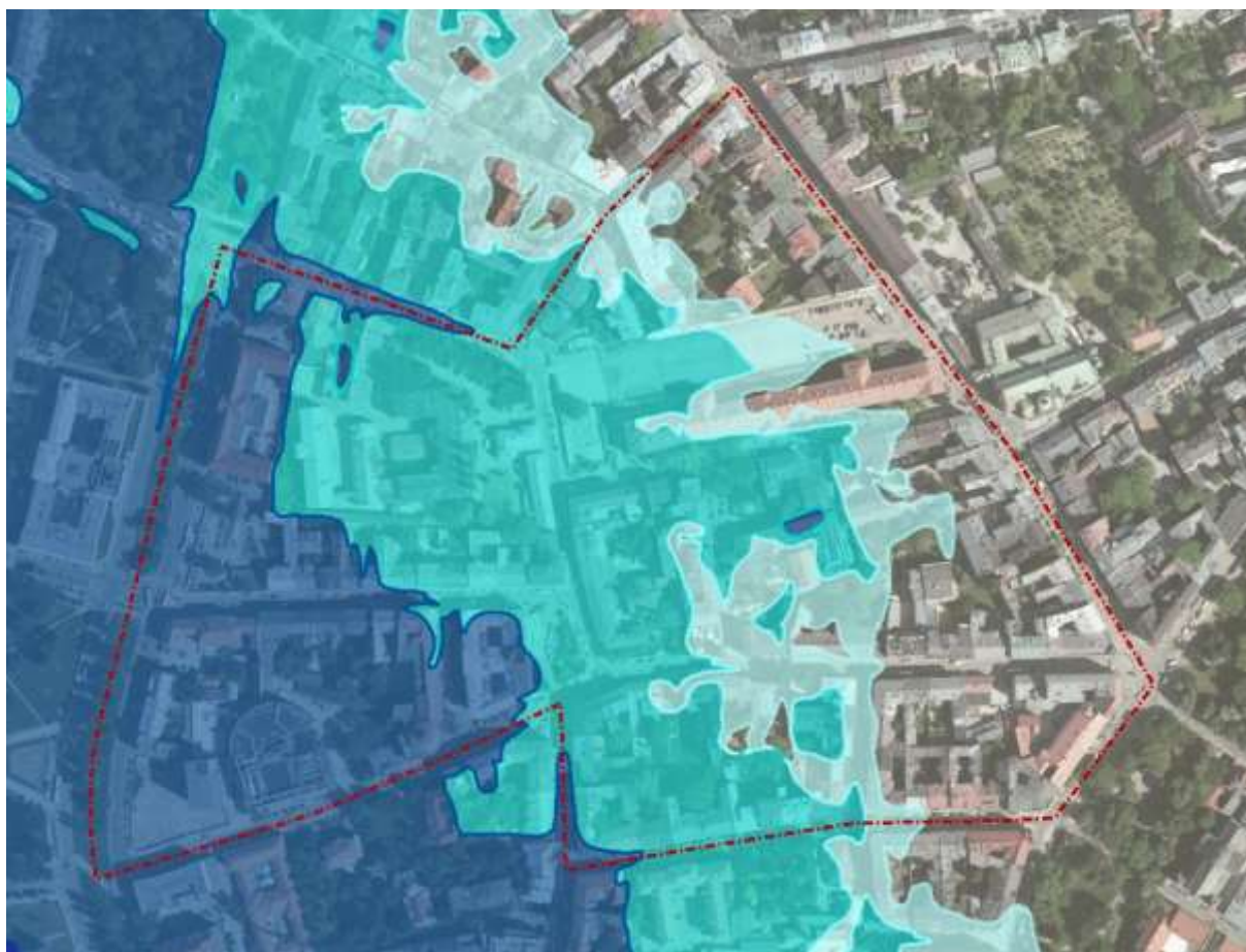
Ryc. 5. Mapa zagrożenia powodziowego wraz z głębokością wody. Tereny w granicach obszaru opracowania, narażone na zalanie w przypadku zniszczenia lub uszkodzenia wału przeciwpowodziowego w przy przyjętym przepływie o średnim prawdopodobieństwie wystąpienia powodzi wynoszącym raz na 100 lat ( Q 1\% ). Głębokość wody: kolor jasnoniebieski 0-0,5 m, ciemnoniebieski 0,5-2 m, granatowy 2-4 m.. (oprac. na podst.[47]) .
