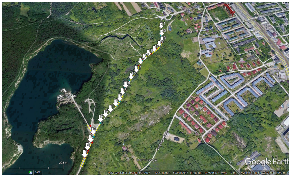
Ryc. 1. Proponowane orientacyjne rozmieszczenie przepustów dla zwierząt. Lokalizacje 3-4, 14-16 oraz 18-20 powinny być rozlokowane co 15 m z uwagi na podwyższone ryzyko śmiertelności płazów.
