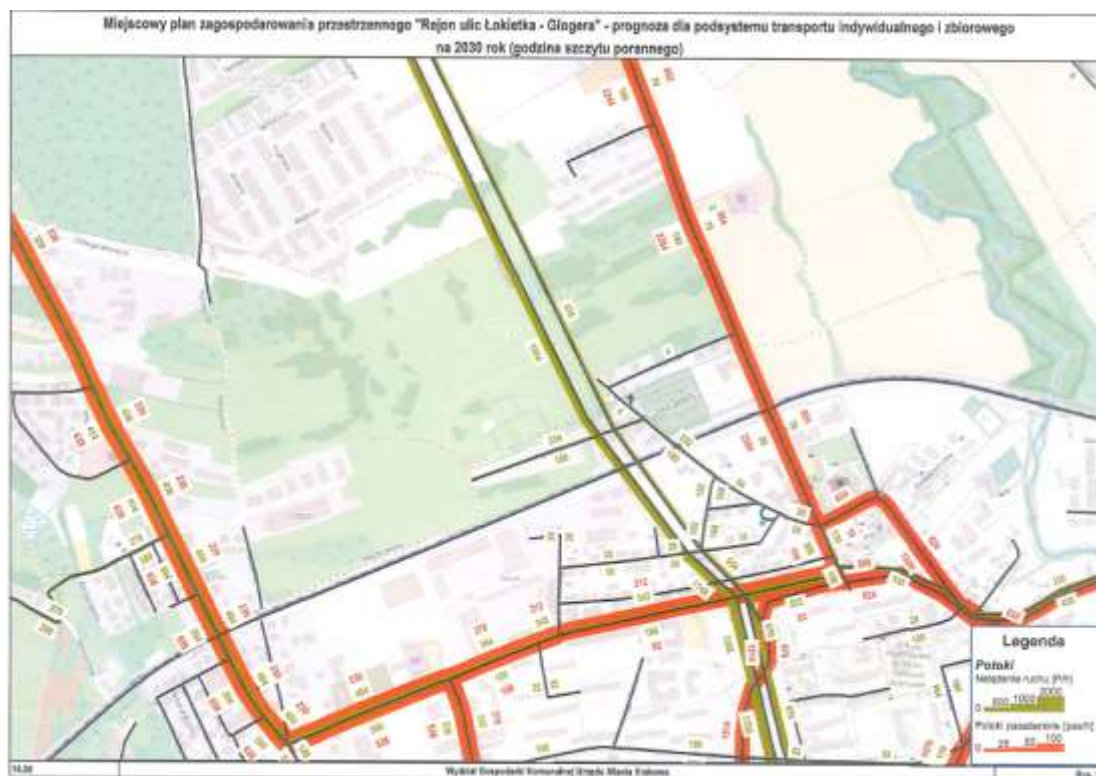
Rycina 10. Natężenie ruchu [p.um./h] – prognoza dla podsystemu transportu indywidualnego i zbiorowego na 2030 (godzina szczytu porannego).
