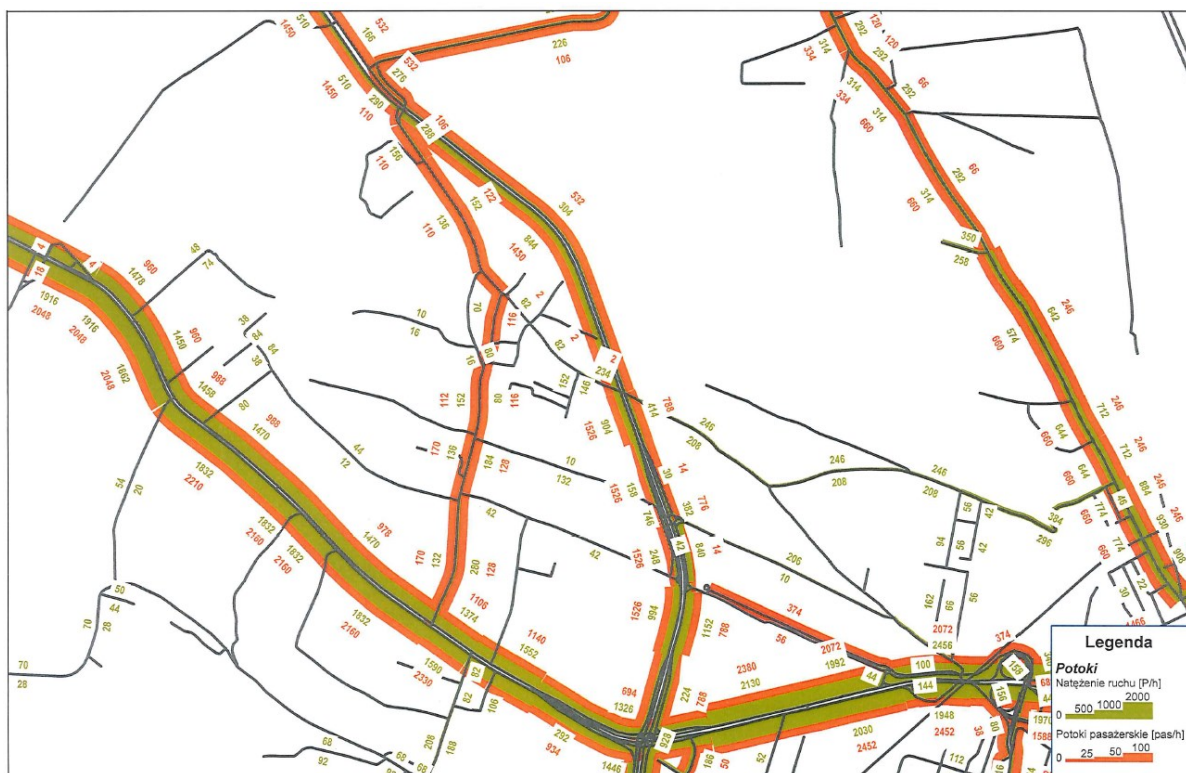
Rysunek 3. Natężenie ruchu [p.um./h] – prognoza dla podsystemu transportu indywidualnego i zbiorowego na 2020 (godzina szczytu porannego).
