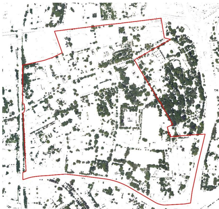
Rys. 9 Zielen powyżej 3m - dane ze skanowania laserowego przeprowadzonego w 2012 r.
