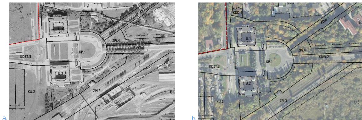
Ryc. 32. Rejon Centrum Administracyjnego - fragment projektu planu zagospodarowania przestrzennego (linie rozgraniczające, oznaczenia, nieprzekraczalne linie zabudowy): (a) na tle fotoplanu z roku 1970r. (b) na tle ortofotomapy 2019r.
