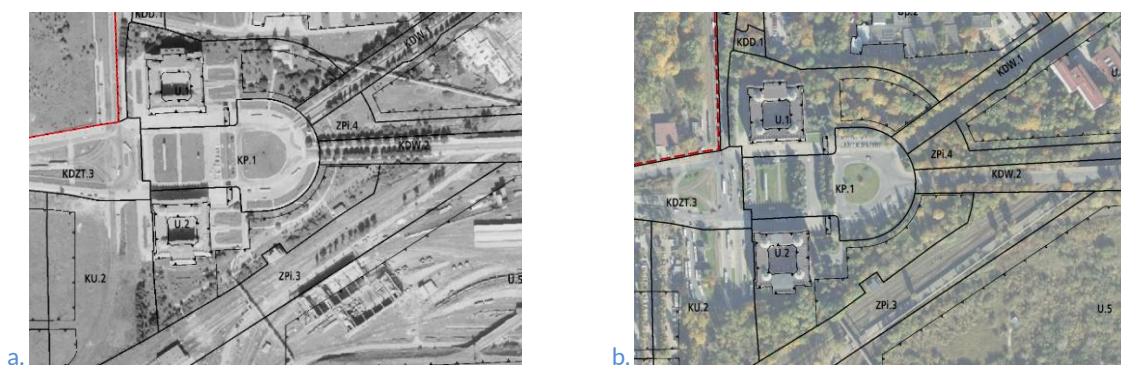
Ryc. 33. Rejon Centrum Administracyjnego - fragment projektu planu zagospodarowania przestrzennego (linie rozgraniczające, oznaczenia, nieprzekraczalne linie zabudowy): (a) na tle fotoplanu z roku 1970r. (b) na tle ortofotomapy 2019r.
