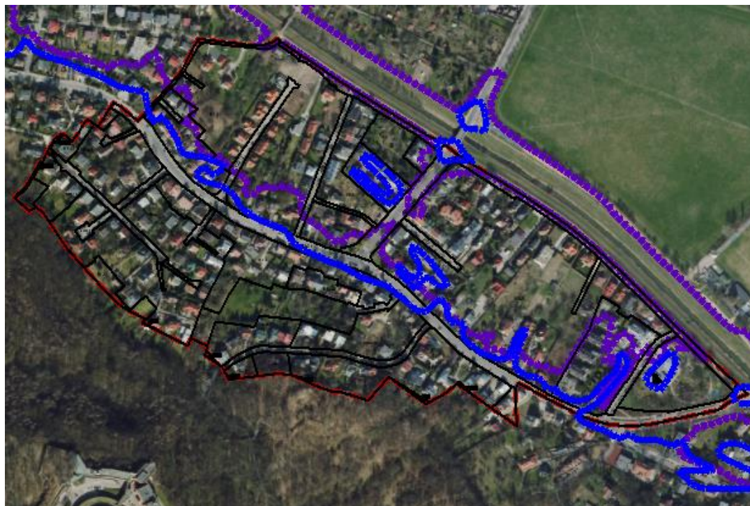
Ryc. 15. Obszary narażone na zalanie w przypadku całkowitego zniszczenia wału przeciwpowodziowego przy wyznaczaniu którego przyjęto przepływ o prawdopodobieństwie wystąpienia 1% (raz na 100 lat) – kolor fioletowy oraz obszary, na których prawdopodobieństwo wystąpienia powodzi jest niskie i wynosi 0,2% (raz na 500 lat) wg map zagrożenia powodziowego – kolor niebieski.
