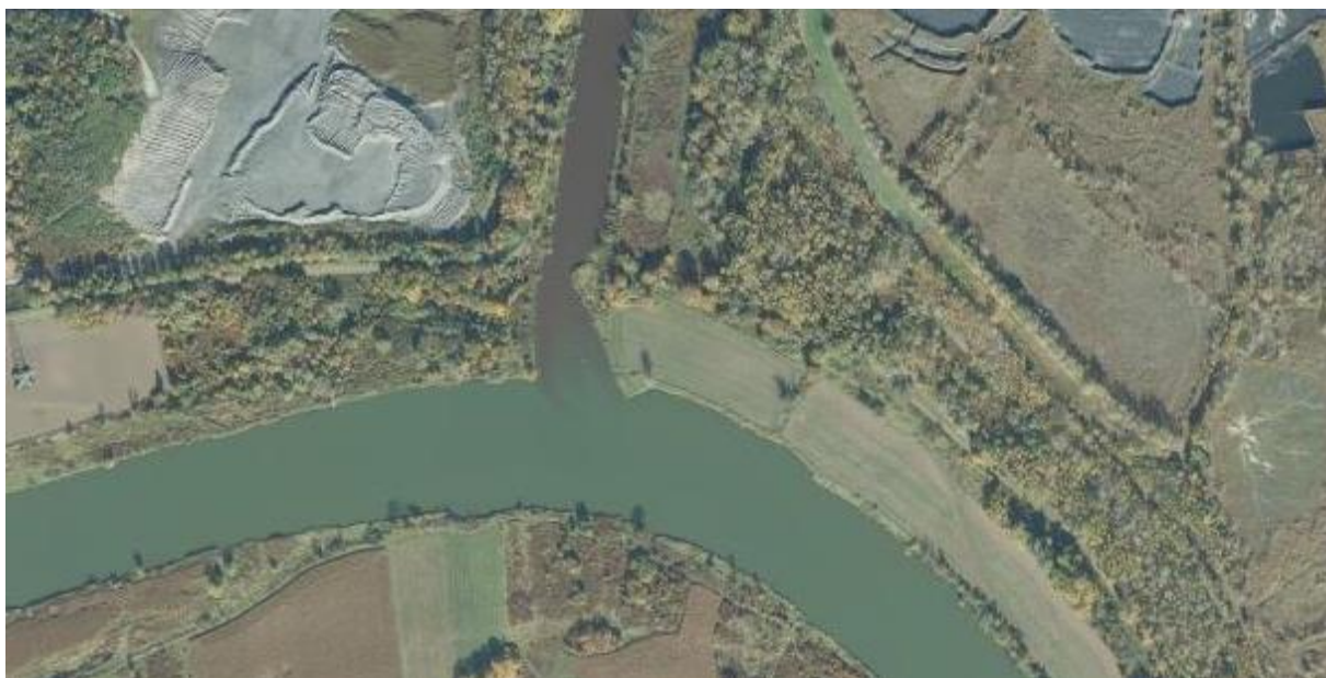
Ryc. 14. Ujście kanału portowego Kujawy do Wisły – ortofotomapa Krakowa z 2019 r. – widoczne zanieczyszczenie wód powierzchniowych.
