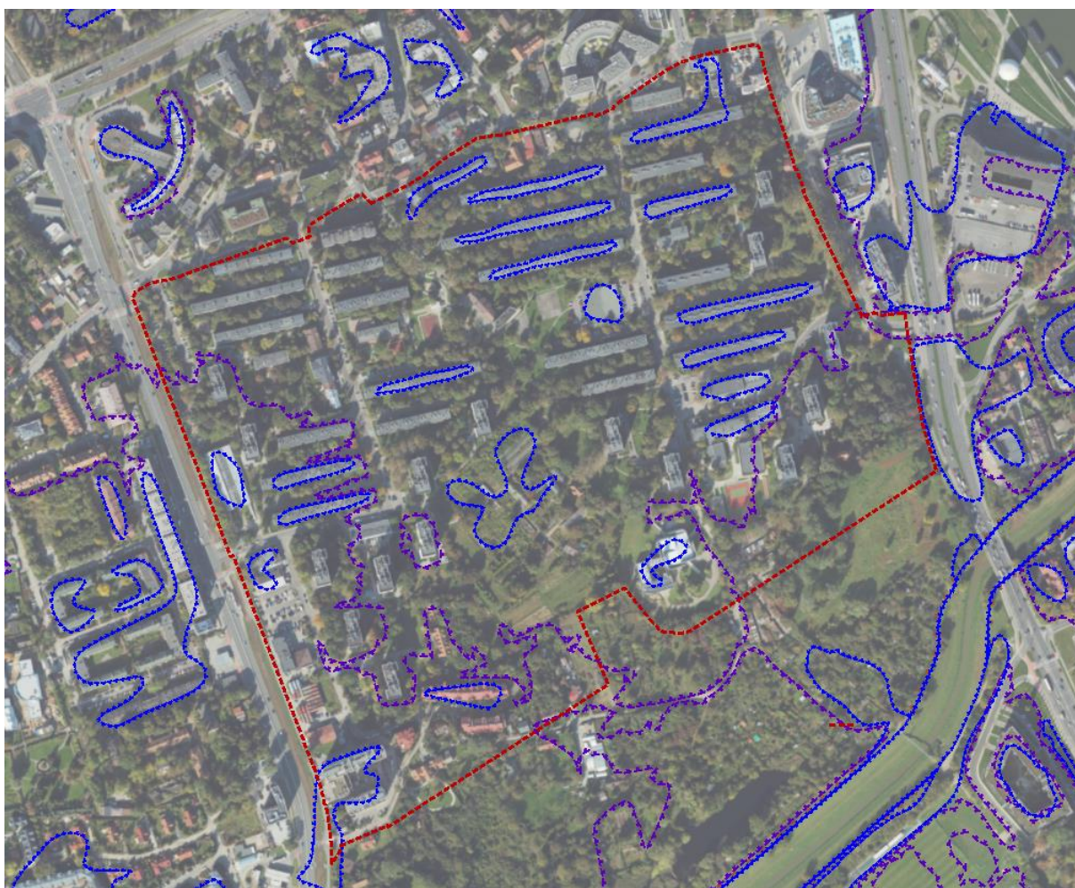
Rysunek 11. Obszar narażony na zalanie w przypadku całkowitego zniszczenia wału przeciwpowodziowego, przy wyznaczaniu którego przyjęto przepływ o prawdopodobieństwie wystąpienia Q 1% (raz na 100 lat) (kolor fioletowy)
