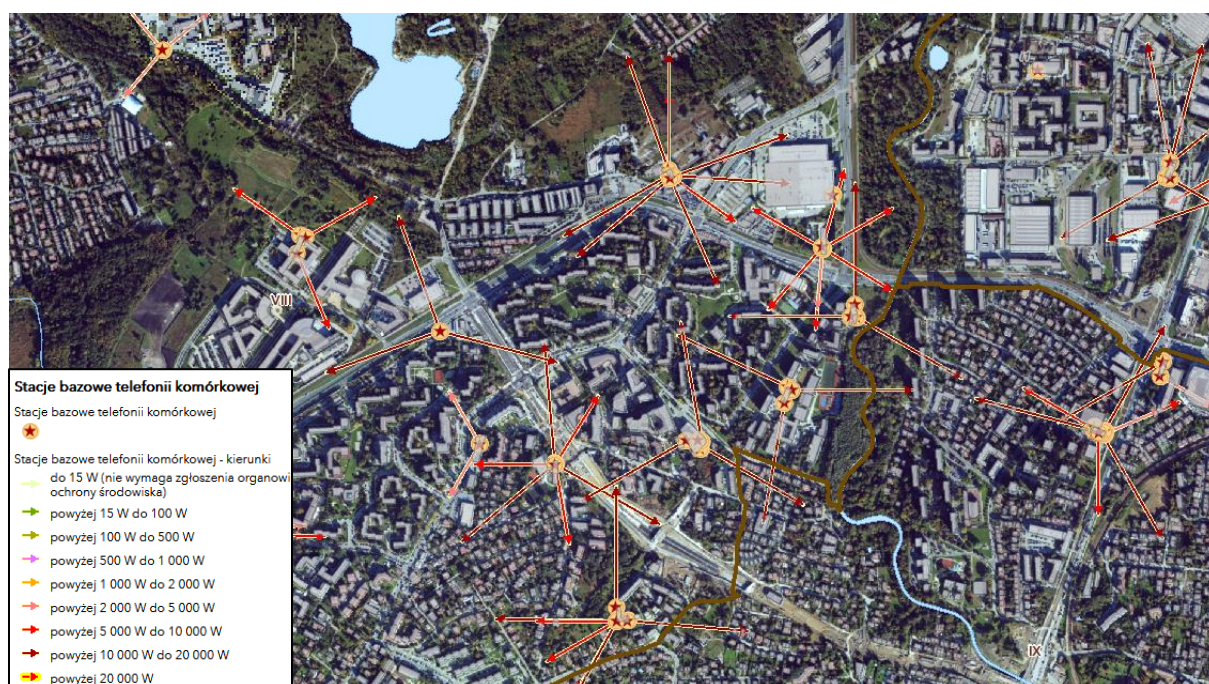
Ryc. 23 Stacje bazowe telefonii komórkowej w rejonie obszaru opracowania – portal Miejskiego Systemu Informacji Przestrzennej – Obserwatorium na tle ortofotomapy 2021 r.
