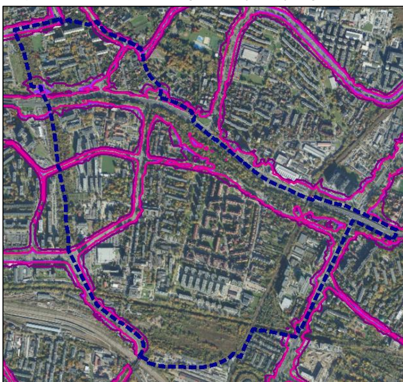
Ryc. 18. Przebieg izofon hałasu drogowego na obszarze opracowania [61].
